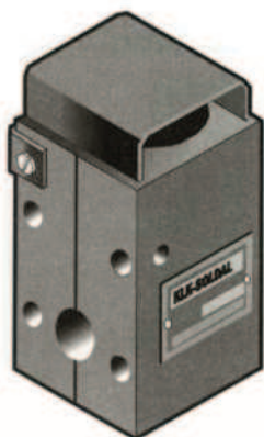
Moule : Le moule est fabriqué à partir d'un bloc de graphite. Un couvercle métallique protège contre les projections de matières incandescentes.
